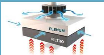
Plenum a tenuta dinamica per una totale assenza di perdite.
